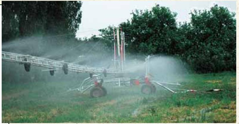
Tournante à 360°, elle permet une complète irrigation même si le champ n'est pas perpendiculaire à la rampe, en s'adaptant au périmètre de la culture et pour éviter les obstacles pendant l'arrosage.
