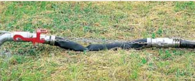
joint rapide universel au tuyau polyéthylène qui permet aux rampes **ALBATROS** d'être utilisées par tout type de machine.
