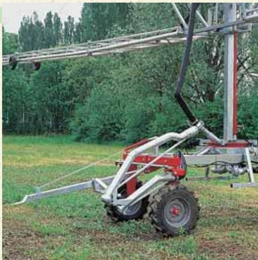
Placement asymétrique du tuyau d'irrigation sur l'axe de la roue, en obtenant ainsi seulement deux voies, avec un réglage de 1,6 - 1,8 - 2,0 m.
