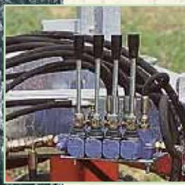
Pour faciliter l'utilisation de la grande rampe **ALBATROS**, la machine a été équipée d'un confortable et pratique panneau de commande, pour la gérance du système hydraulique qui commande:
